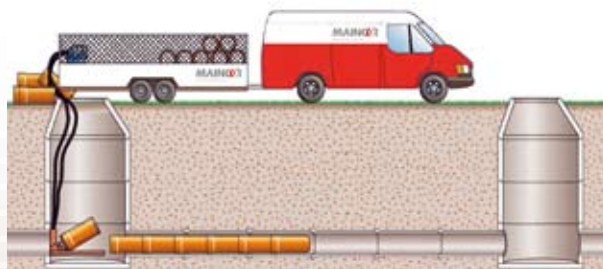
Einschub durch Hydraulik
